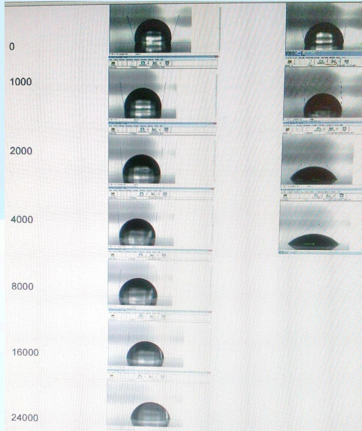
Ensayos de Abrasión sobre revestimientos
